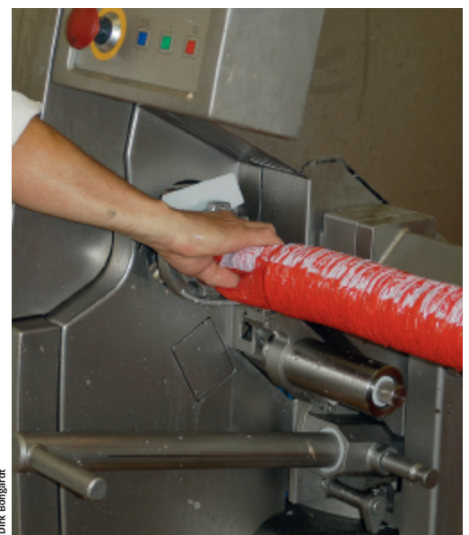
Mit einer Geschwindigkeit von bis zu 160 Takten pro Minute verdient der Doppel-Clip-Automat die Bestnote in Sachen „Arbeitstempo“.
