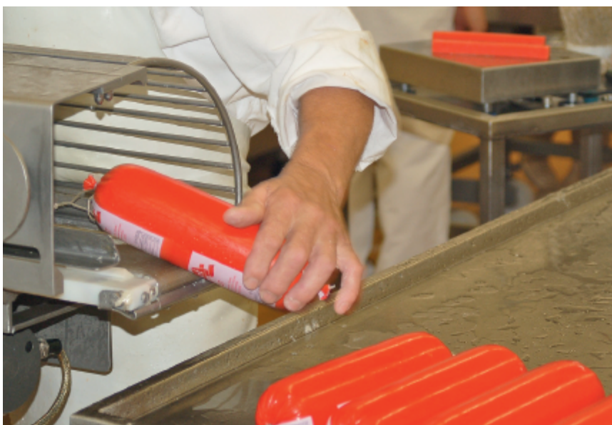
Der FCA 160 verschleißt alle Faser- und Collagendärme von Kaliber 38 bis 120 mm sowie Kunststoffdärme bis Kaliber 160 mm.
