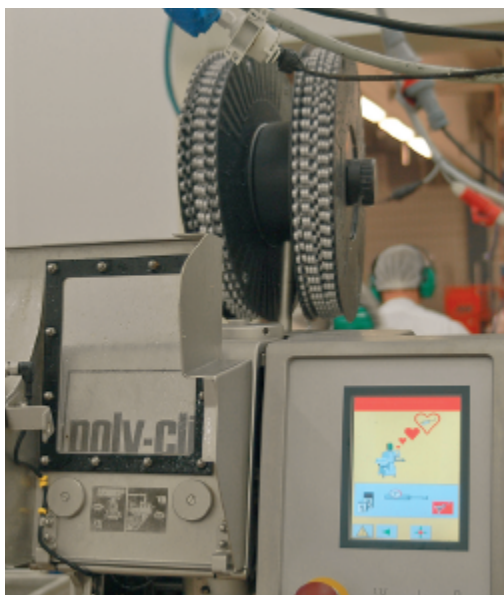
Mit der „Easy Touch“-Steuerung lassen sich alle relevanten Parameter zu einem Produkt als Programm speichern und jederzeit abrufen.
